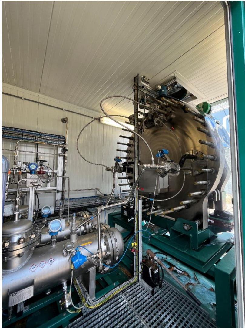
Figuur 3 Testen van opgeschaalde stack op druk in Battolyser testfaciliteit
