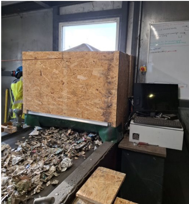
Hardware waarmee de uiteindelijk demonstratie is uitgevoerd. De LIBS-sensor is vanwege laser veiligheid afgeschermd met een doos.
