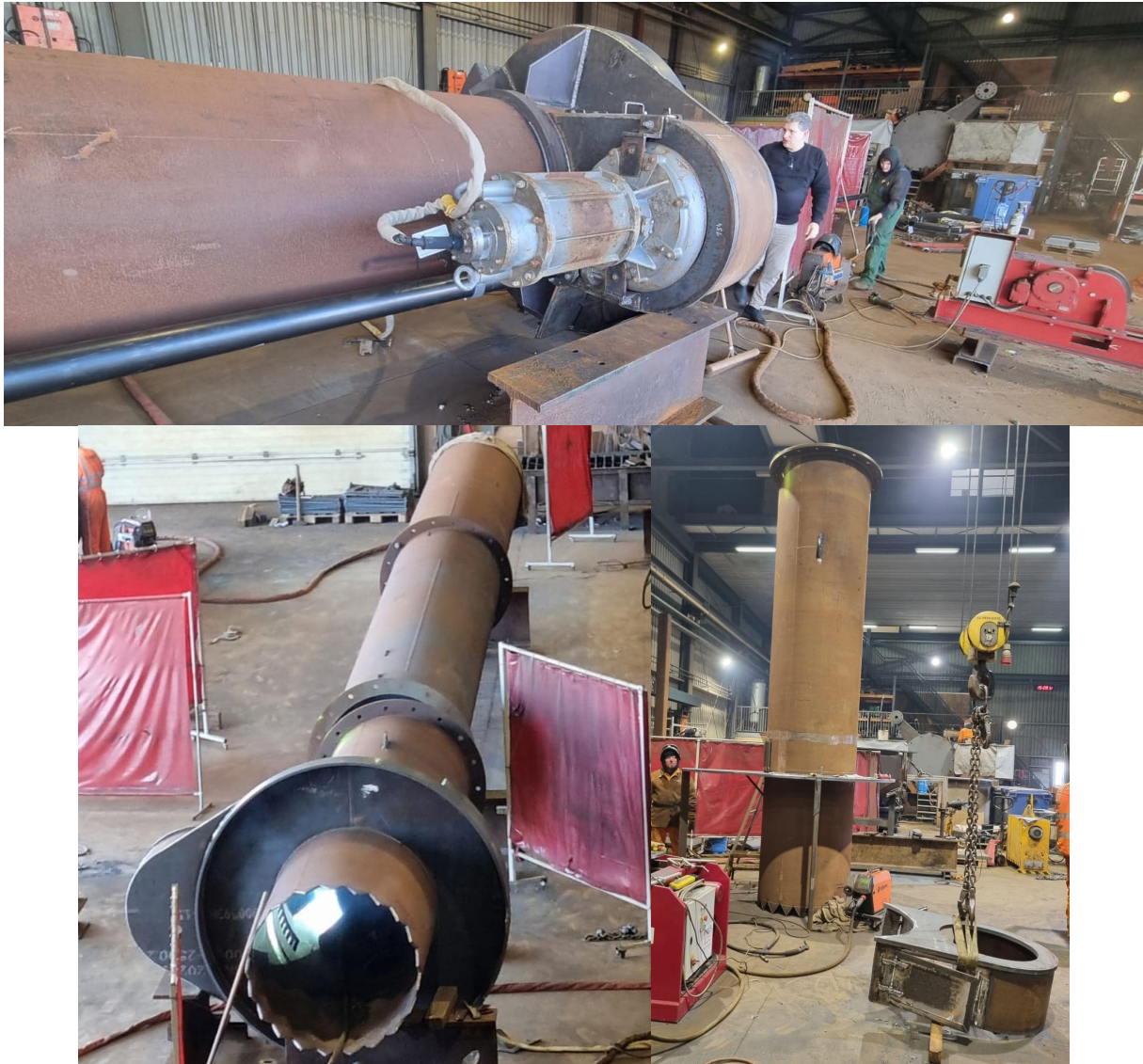
Figuur 2: Bovenste plaatje is de complete PCD met flens, pomp en terugvoerbuis die het grout naar boven leidt. De onderste twee plaatjes geven een indruk van de verschillende lengtedelen, en de pompkamer die bevestigd wordt aan de boorbuis. Afhankelijk van de diepte van het maaiveld, worden andere lengtedelen gebruikt.
