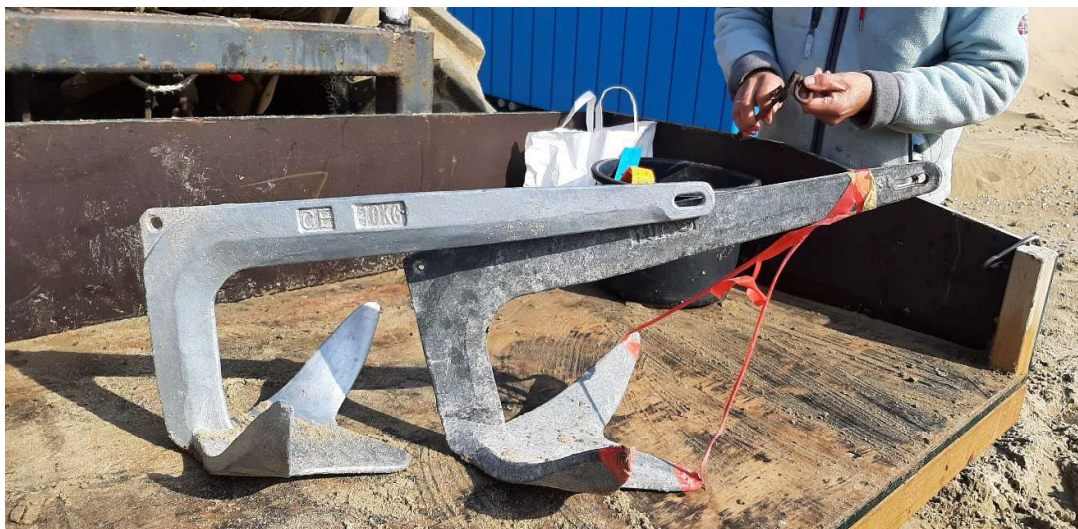
Figuur 3 Twee Bruce ankers die enigszins verschillen in de hoek van het blad. De rode tape was van een test voor inhaakpreventie.
