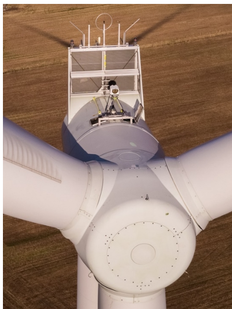
Figuur 2.13: Drie iSpin anemometers in de spinner, en de WCN lidar op de gondel
