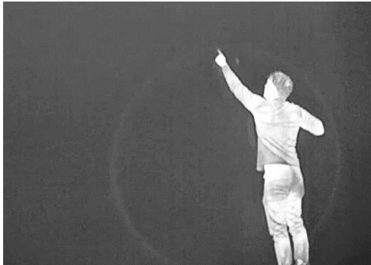
Figuur 2.6: TNO medewerker neemt de cirkelvormige gescande laserpatroon van de ZDM lidar die via het IR camera beeld zichtbaar wordt over op de wand
