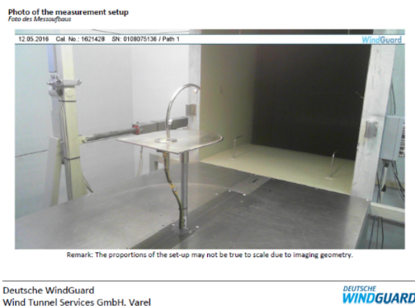
Figuur 2.2: Windtunnel kalibratie van iSpin sensor
