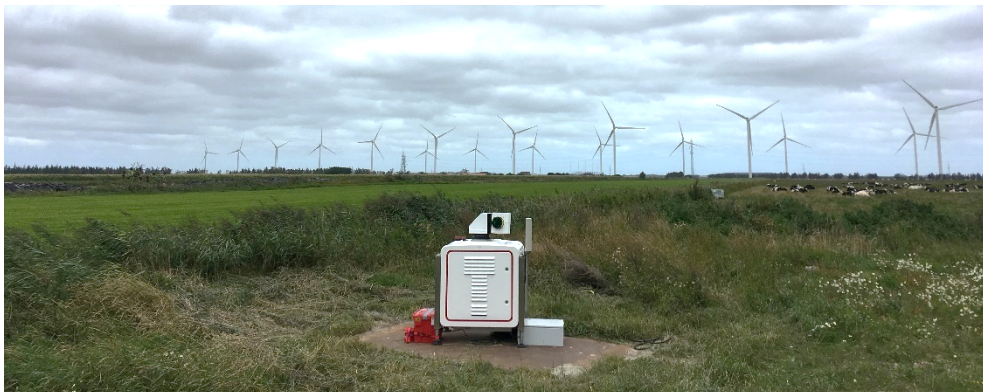
Figuur 2.14: Scanning lidar geplaatst 1100 meter ten zuidwesten van de wind turbines (zie Figuur 2.1 voor de positionering ten opzichte van het windpark)
