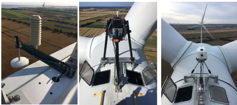
Figuur 2.12: Sensoren voor luchtdruk, temperatuur en luchtvochtigheid (links), ZDM lidar (midden), WCN lidar (rechts)
