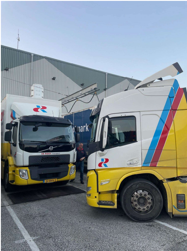
Afbeelding 5: De dockstation variant waaronder e-trucks kunnen doorrijden
