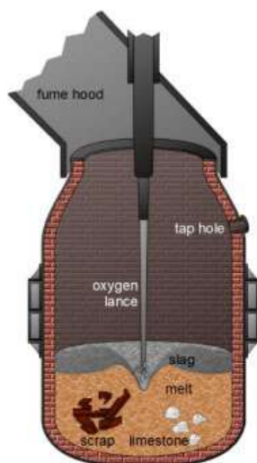
Figuur 2.1 Slakvorming tijdens Het Linz-Donawitz-proces, ook bekend als het oxystaalprocedé.
