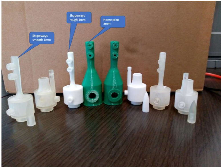
Figuur 5.1: Een aantal van de Lavalstraalpijpen die zijn getest.
