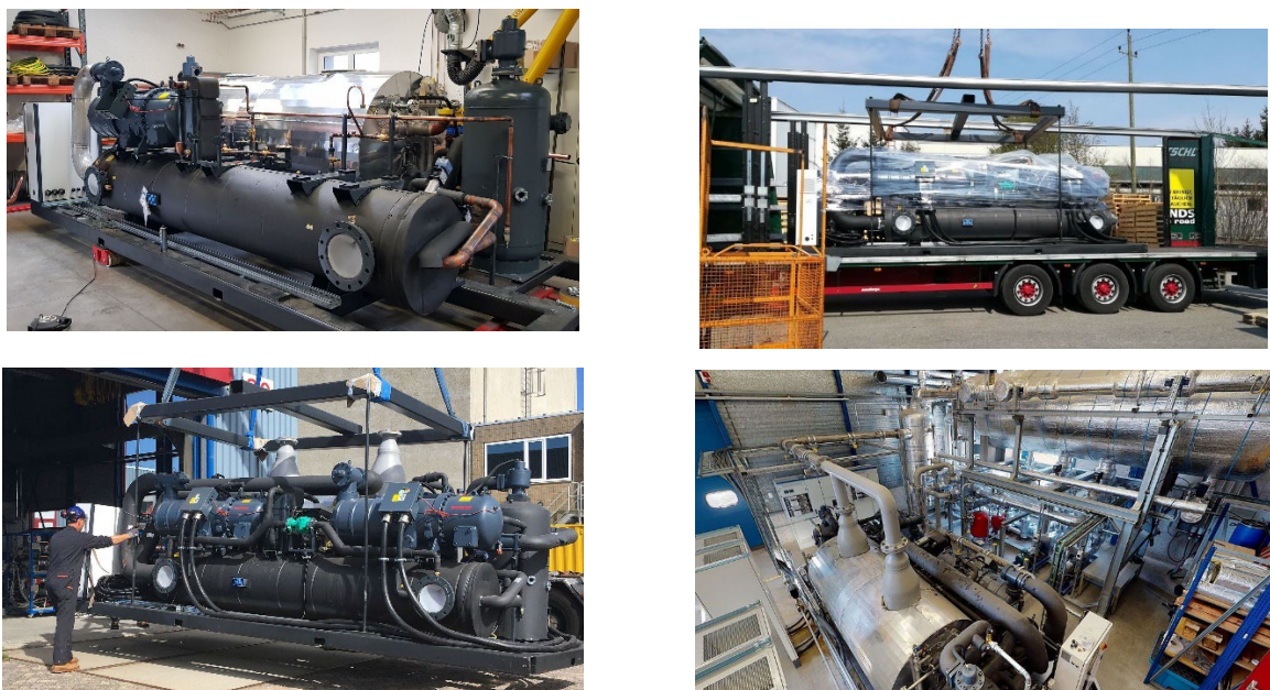
Figuur 2 LowCapex warmtepomp bij Ochsner (linksboven), op transport (rechtsboven), arriverend bij TNO (linksonder) en aangesloten op de TNO Full Scale Test Rig (rechtsonder)
