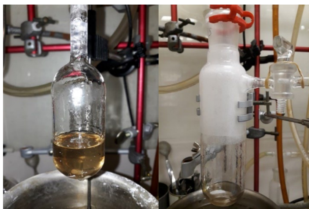
Figuur 3.1: Links het ruwe reactiemengsel met deels gepolymeriseerde hoofdketen en deels het startmateriaal en rechts het gescheiden mengsel met onderin de hoofdketen en bovenin het startmateriaal.
