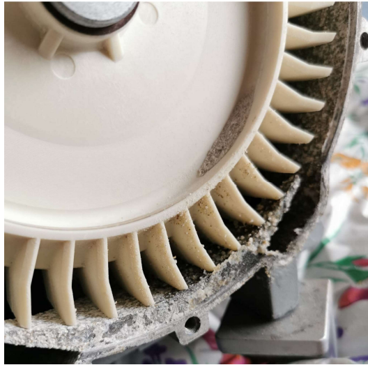
Figuur 4: Zoutaanslag in blower
