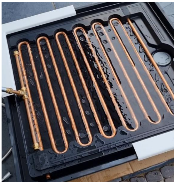
Figuur 2 – Stromingstest met het eerste prototype X-Tray
