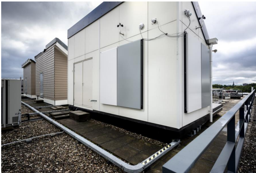
Koelen met de warmtewinpanelen op SolarBEAT.
