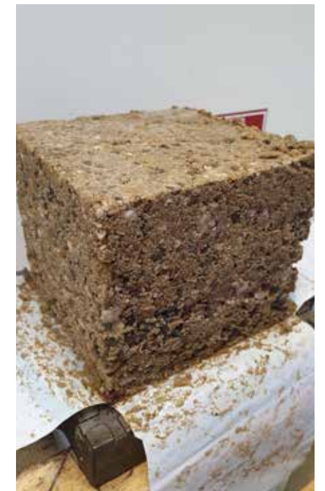
Biobeton kubus proefstuk na het ontkisten.
