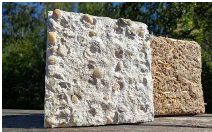
Biobeton kubussen; 1 met grind en 1 met miscanthus.
