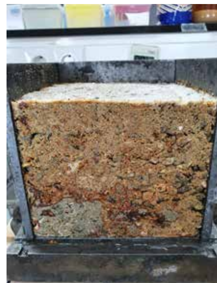
Biobeton proefstuk in de kubusmal.
