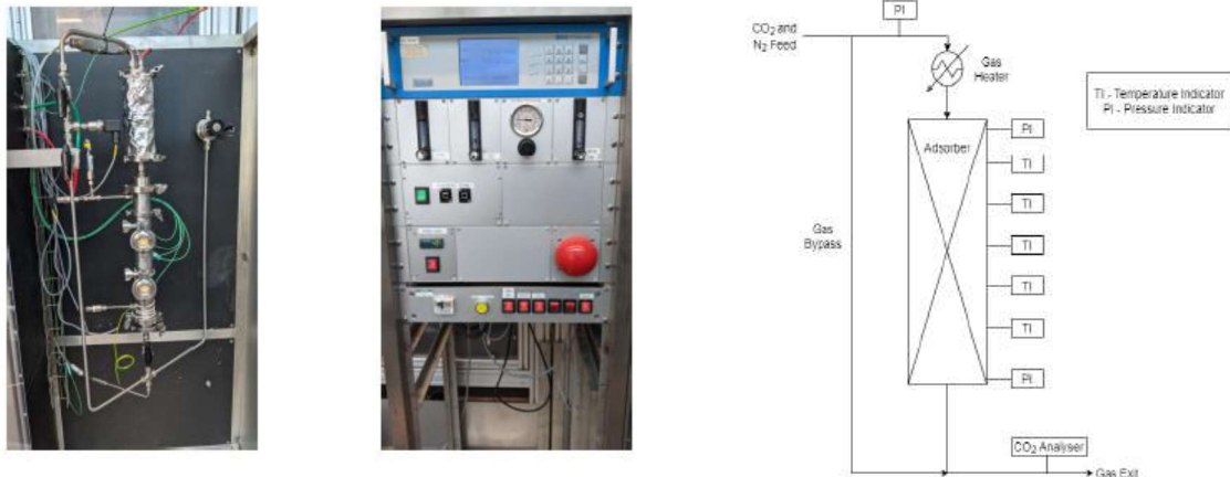
Figuur 6: Testreactor (links), besturing (midden) en processchema (rechts) van de 'proof-of-principle' experimenten bij de Universiteit Twente
