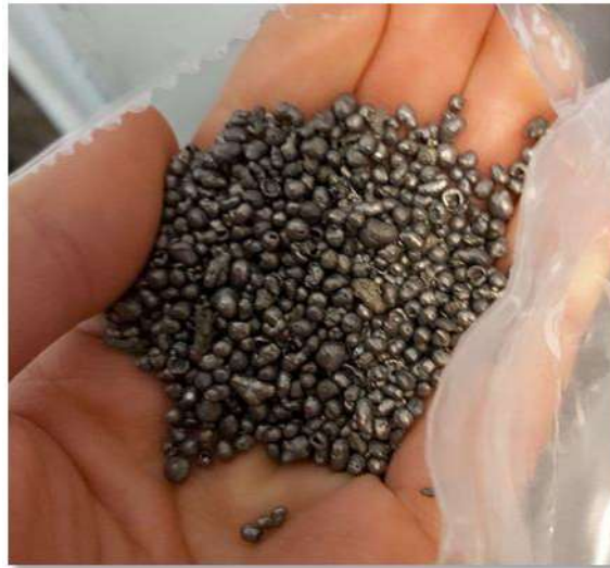
Figuur 12: De stalen korrels die gebruikt zijn om de thermische capaciteit van het sorbent te verhogen
