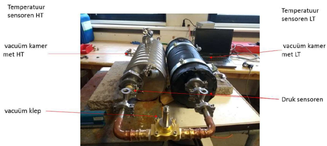
Figuur 44 Test opstelling vacuüm klep
