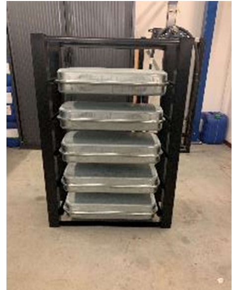
Figuur 32 Opstelling van de platte modules in een skid
