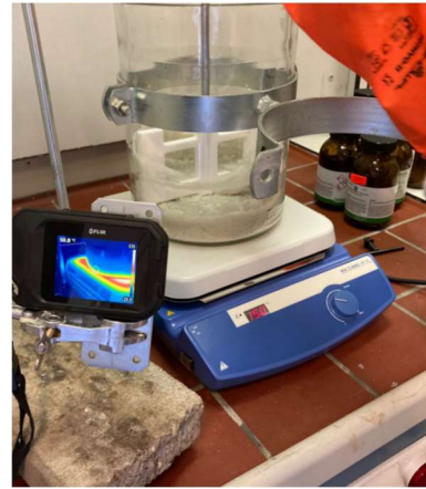
Figuur 29 Opstelling voor smelten \text{Na}_2\text{S}
