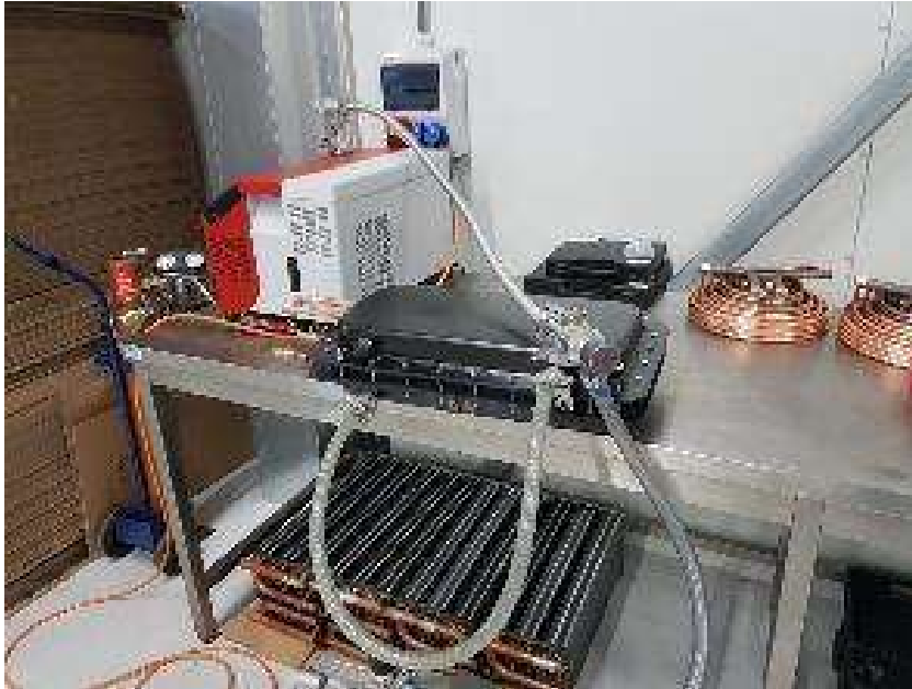
Figuur 68 Samengebouwde module aangesloten op de vacuüm test installatie
