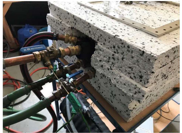
Figuur 36 TCES in testopstelling
