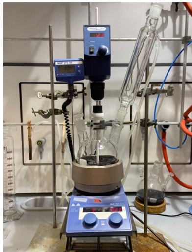
Figuur 4: 0.5 liter solvent-based testopstelling van ReSolved Technologies die in het kader van dit project is gebouwd
