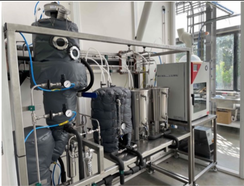
Figuur 3: 20 liter solvent-based testopstelling van ReSolved Technologies die in het kader van dit project is gebouwd
