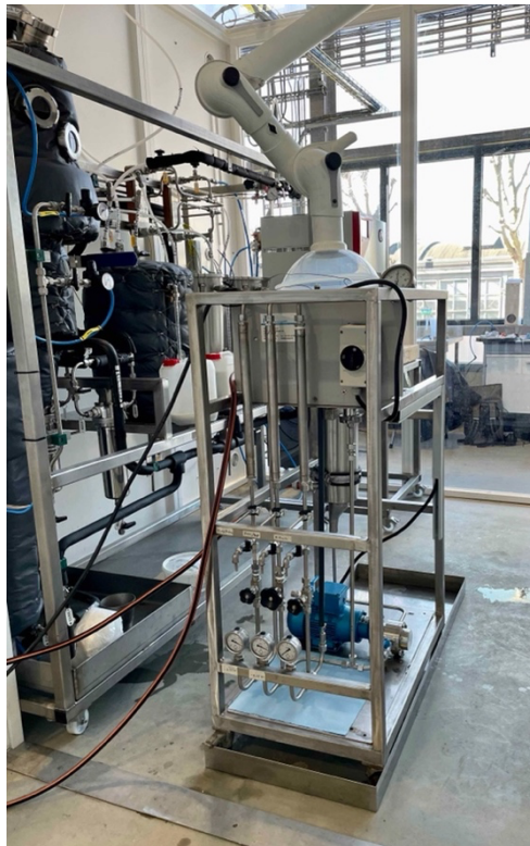
Figuur 5: Membraanfiltratie testopstelling van ReSolved Technologies op lab schaal die in het kader van dit project is gebouwd
