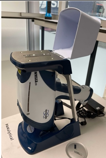
Figuur 7: XRF analyser bij Prodin BV. XRF analyse is in dit project gebruikt voor het bepalen van het broomgehalte van kunststoffen met broomhoudende vlamvertragers
