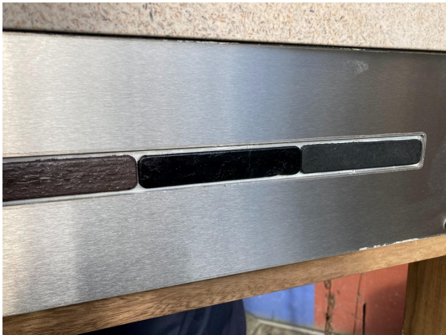
Gevelpaneelsamples van Re-plex (donkere rechthoeken in aluminium frame). Kleurverschillen komen door het testen van verschillende coatings. © AMS Institute
