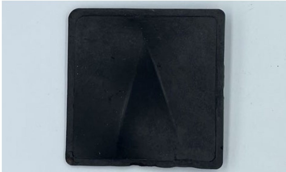
Een 3D gevelpaneel van Re-plex © AMS Institute
