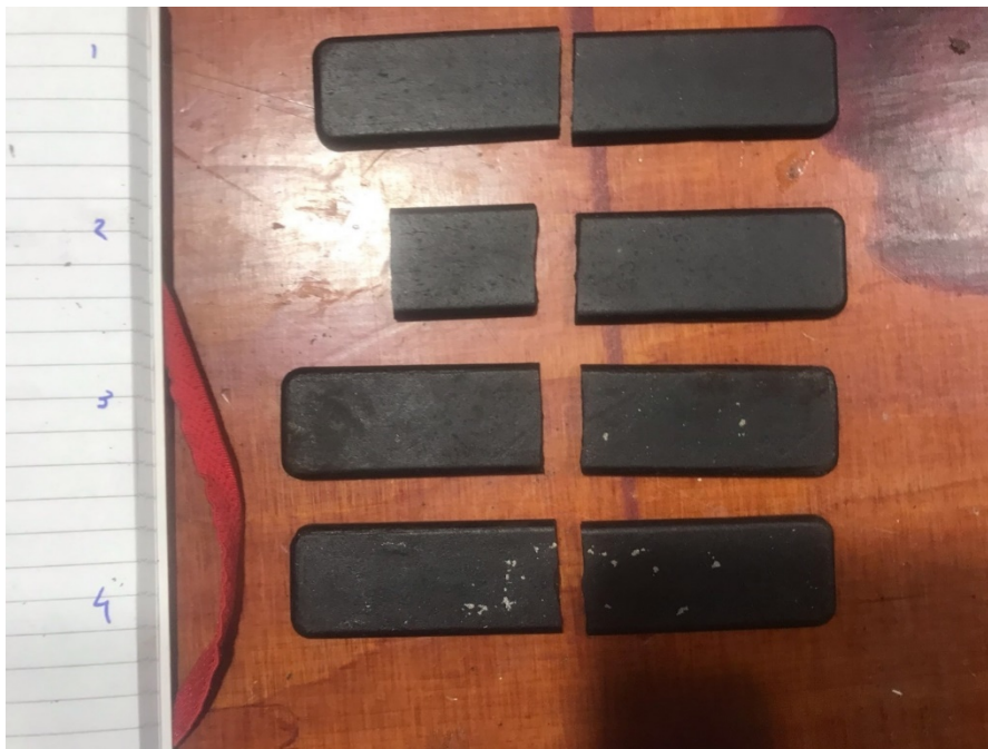
Re-plex samples na een three-point bending test om de stijfheid te meten © AMS Institute
