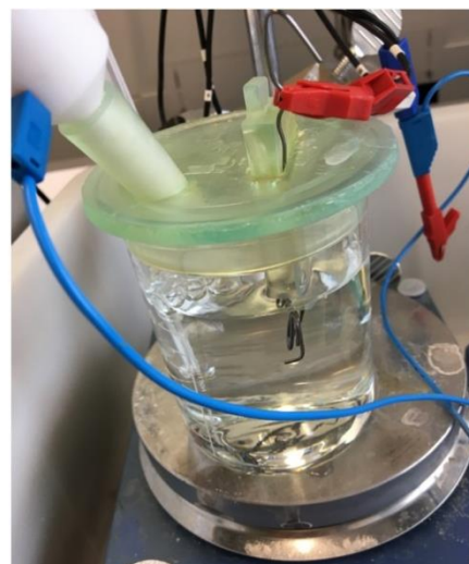
Figure 8 Beschrijving van de ex-situ testopstelling en testomstandigheden tijdens de elektrochemische evaluatie van de met sALD afgezette IrO x -katalysator op Ti PTL's.
