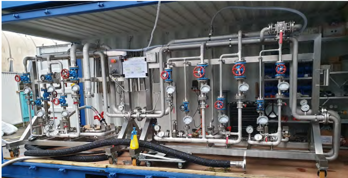
Figuur 4.3: Brandstof debiet meting met rotameters.
