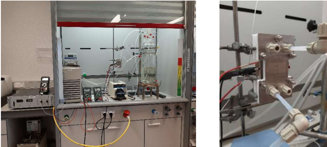
Figuur 9 Kolbe elektrolyse opstelling (links) en de elektrochemische reactor (rechts)
