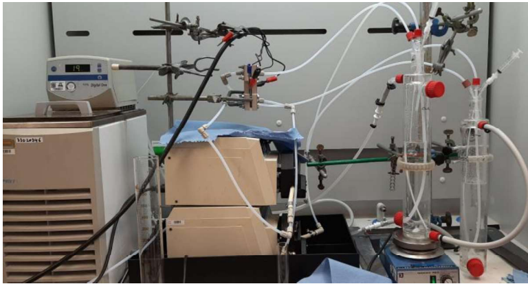
Figuur 6 Foto van de gebruikte flow opstelling (links) en de elektrochemische flow-reactor (rechts)
