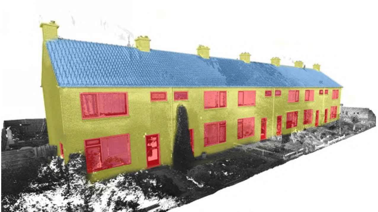
Voorbeeld van een gecategoriseerde mesh: De kozijnen, gevels en daken zijn herkend
