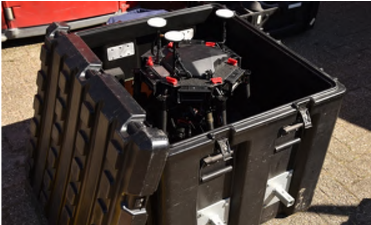
De drie witte schotelletjes op de drone zijn de RTK sensoren
