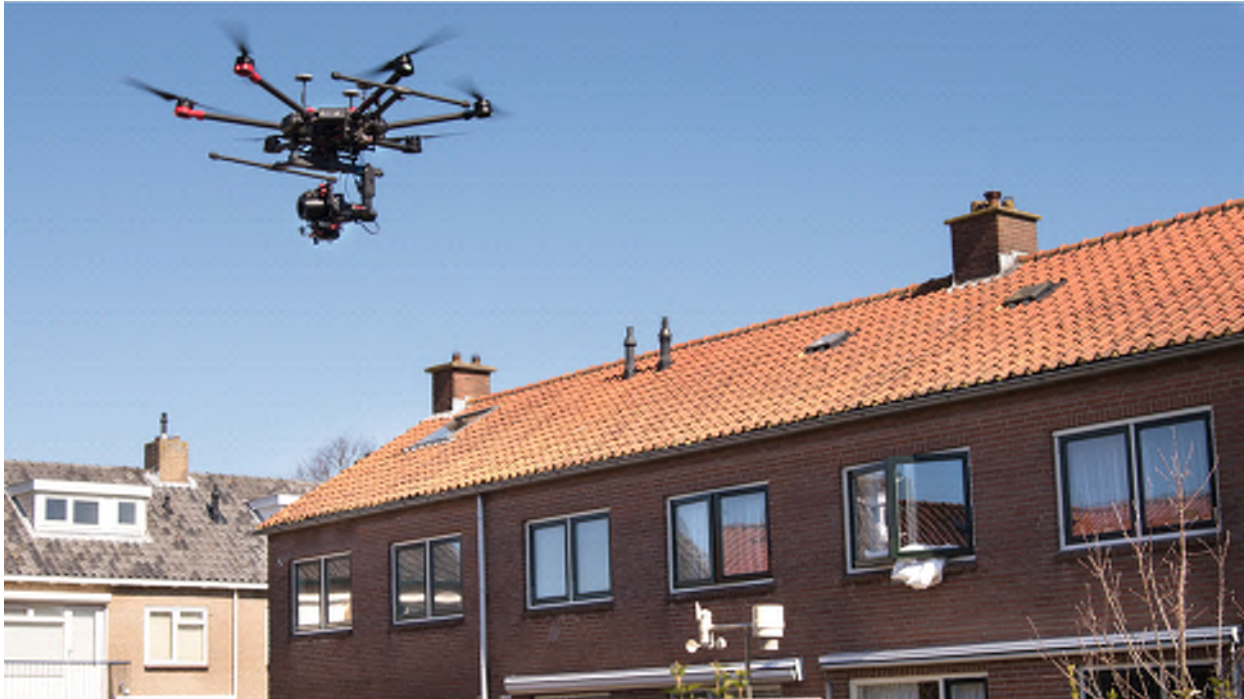
Drone met camera (fotogrammetrie)
