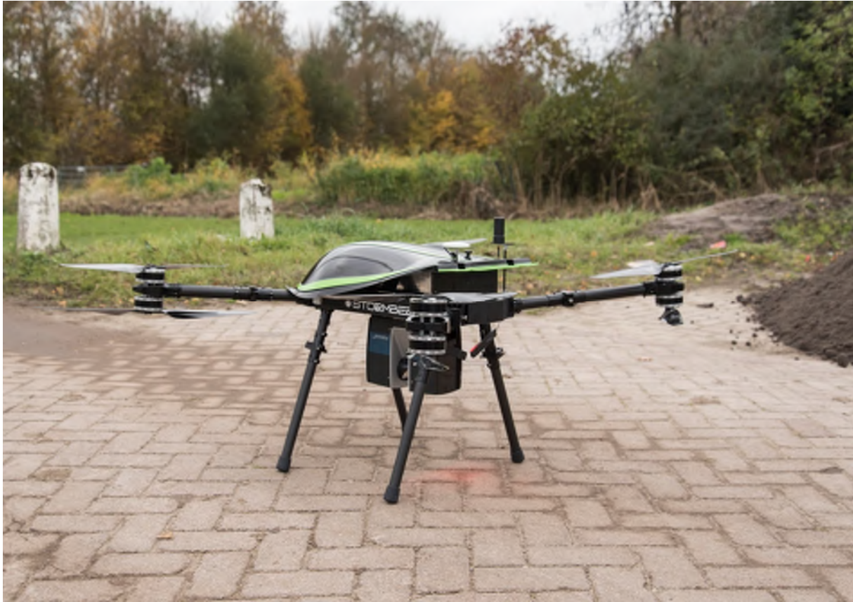
Drone met laserscanner
