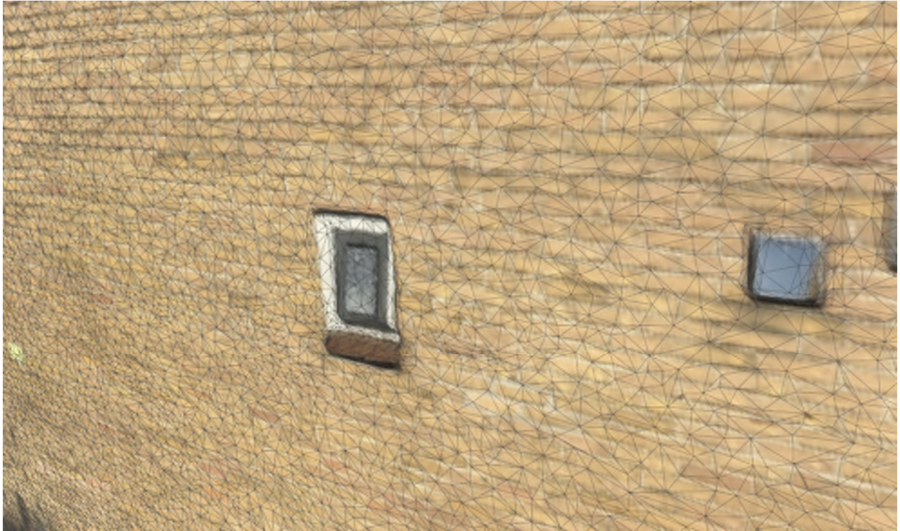
Een 3D mesh – driehoeksvlakjes die met elkaar verbonden zijn
