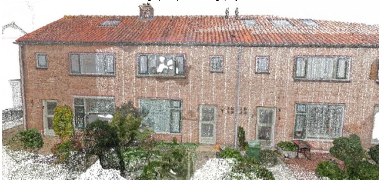
Alle kaders worden op de pointcloud geprojecteerd
