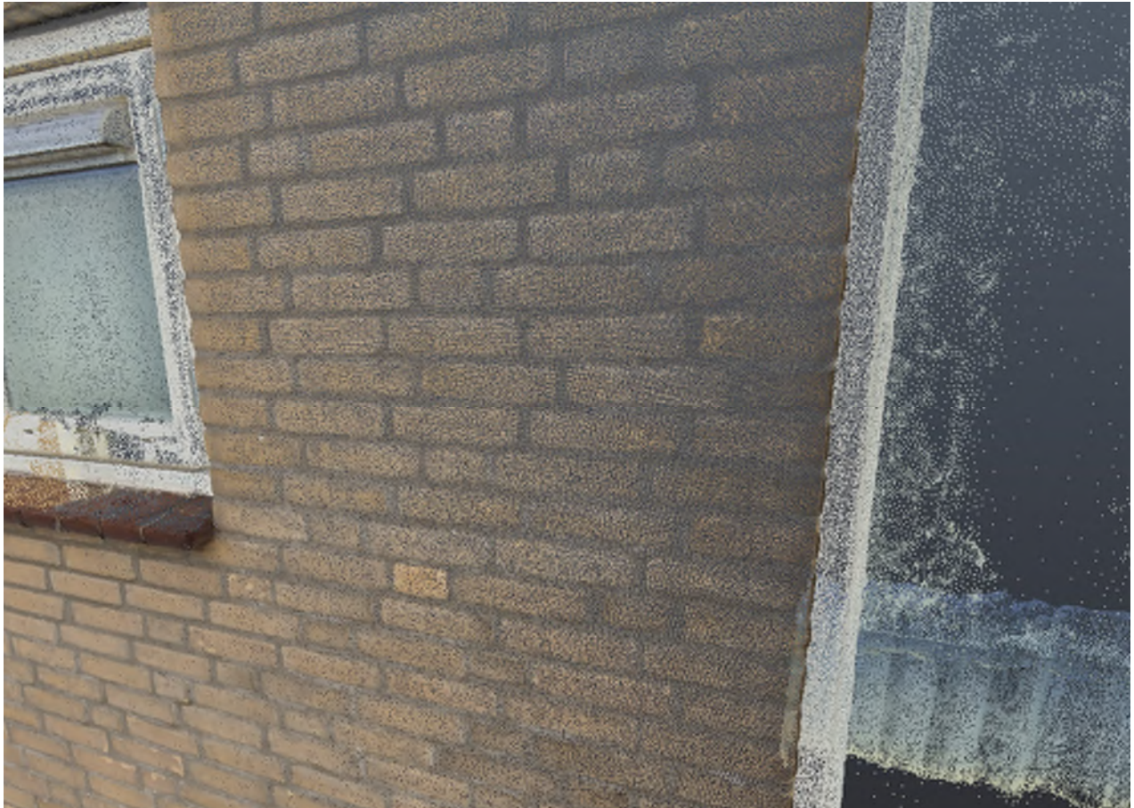
Een pointcloud - het 3D model bestaat uit allemaal puntjes
