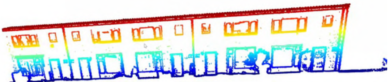
Diepte bepalen in het gevelvlak
