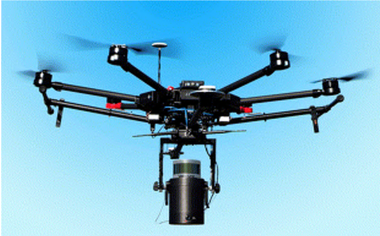
Drone met LiDAR scanner
