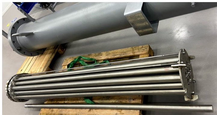
Figuur 4: Samenstelling van gevulde PCM buizen, voor plaatsing in het drukvat.
