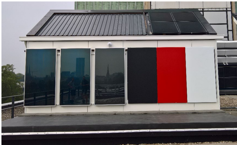
Figuur 2 Afgedekte en onafgedekte FITS-panelen in de testopstelling bij SEAC.
