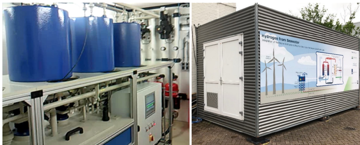
Figuur 3: Membraandestillatiesysteem (links) in transporteerbaar lab met Visual van het project op de buitenwand (rechts).
