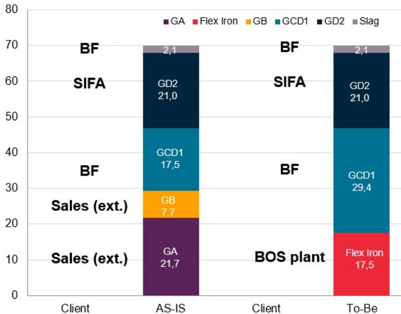
Figuur 9: Producten (in 1.000 ton) met afzet/klanten bij de huidige en toekomstige slakverwerking
