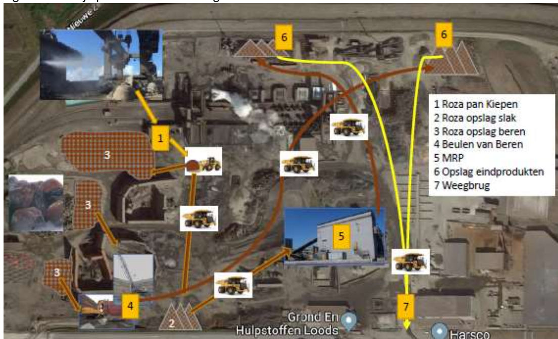
Figuur 2: Bedrijfsproces van verwerking ROZA-slak
