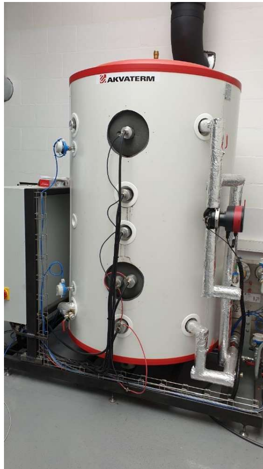
Figuur 1: Prototype Waterbatterij met een inhoud van 1500l.
