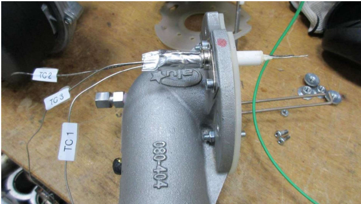
Foto aangepaste brander met thermokoppels
