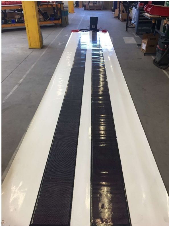
Figuur 26: Integratie van de 8 m modules met Evalon dakbedekkingsmateriaal
