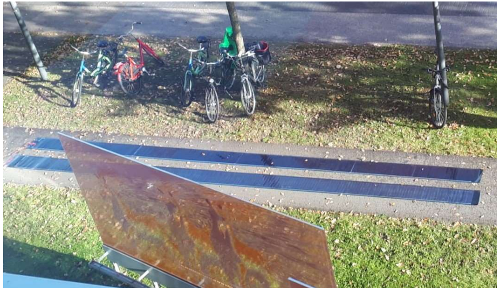
Figuur 25: Functionaliteitstest van de 8 meter modules in de buitenlucht
