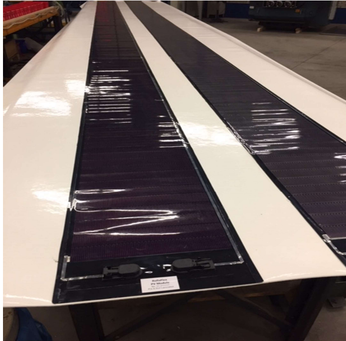
Figuur 1 : 8meter PV modules geïntegreerd op dakbedekkings materiaal
