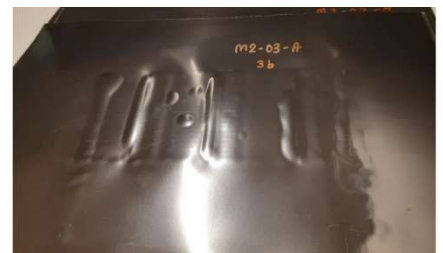
Figuur 13: zichtbare delaminatie
