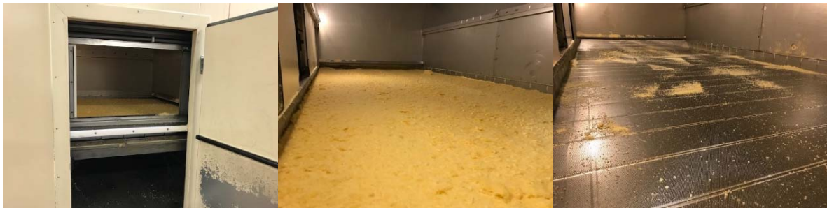
Figuur 2: Van links naar rechts geopende deur tunnel, laag kaas op lopende band en geperforeerde retourband
