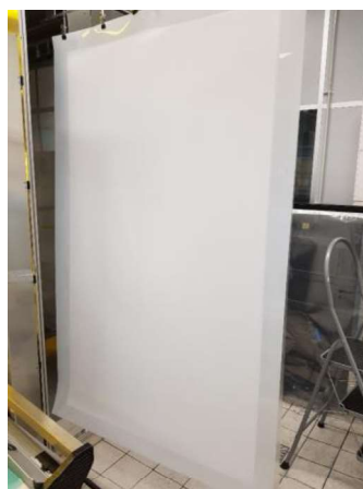
Figuur 2.4 Nano-imprintlithografie stempel, opgeschaald naar de afmetingen van een 60-cel bifacial module.
