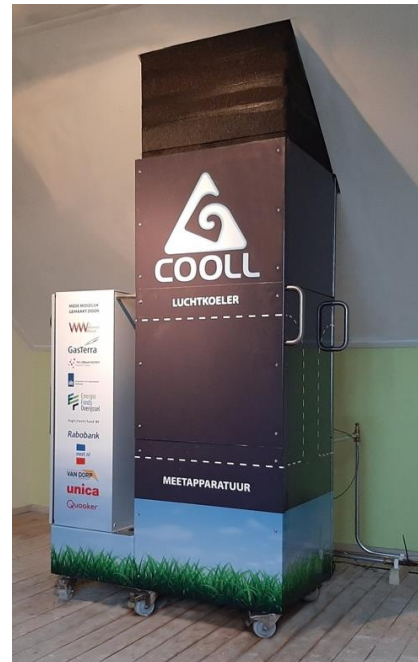
Figuur 4. Functioneel model 2 van de warmtepomp, als test in een woning in Uden (winter 2020-2021).
