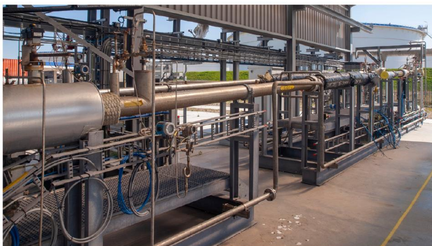
Figuur 3: Flowmeter-under-Test (MuT)-sectie van de LNG kalibratie- en testfaciliteit. Foto uit [7].
