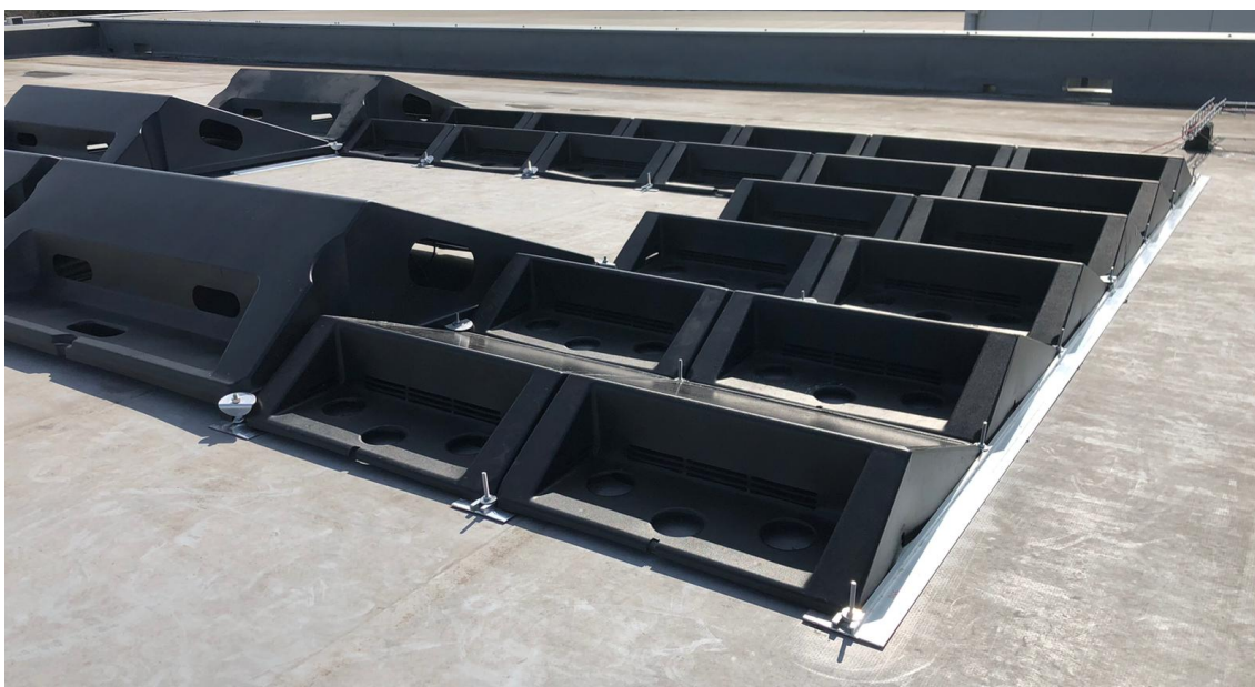
Afbeelding 14: test met nieuwe aluminium profielen met zowel CS140 als handmatig aangepaste CS55 modules.
