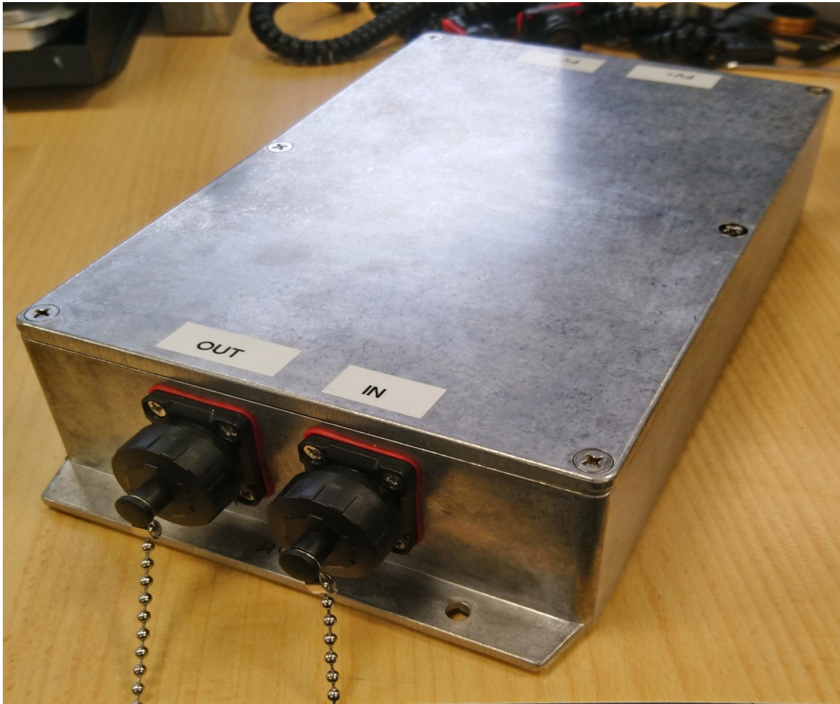
Afbeelding 6: prototype step-up converter van Heliox.
