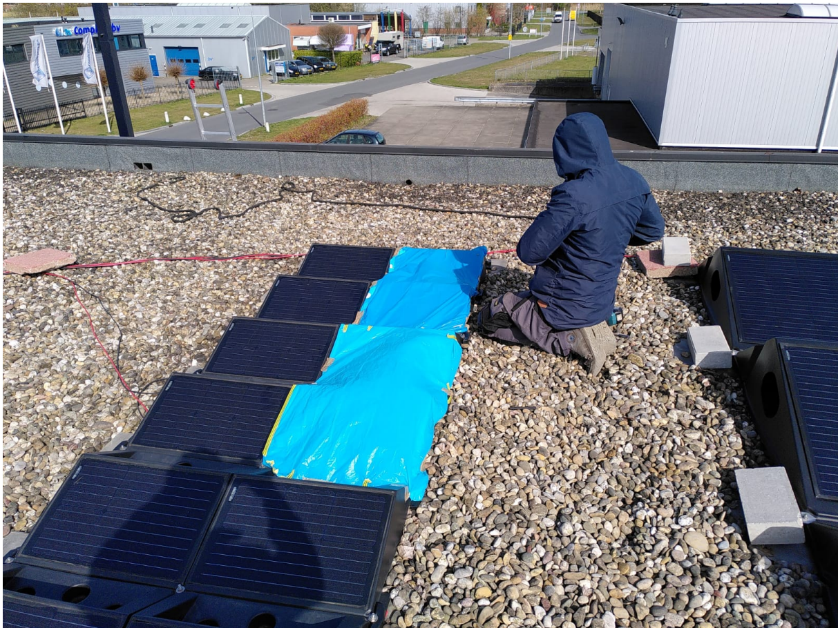
Afbeelding 17: Schaduwtesten van de CS55 modules met step-up converters op de testlocatie in Lelystad.
