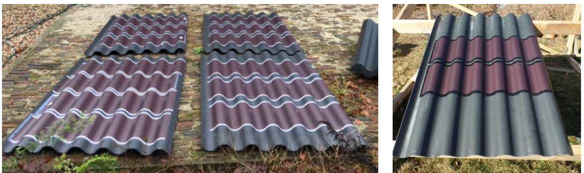
Figuur 6.2 Voorbeelden van de modulaire opbouw van PV-folie op Eternit golfplaten.
