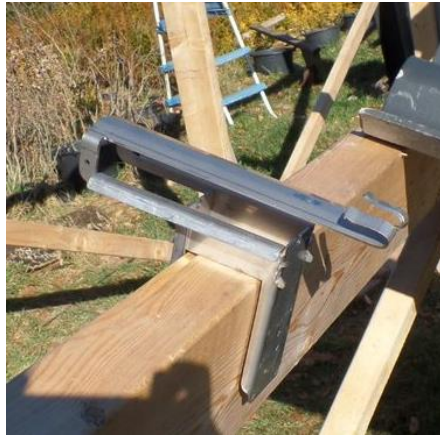
Figuur 6.4 Ontwikkelde versie van de gerealiseerde beugel als docking concept.
