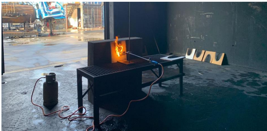
Testopstelling voor uitvoeren van indicatieve brandtesten.
