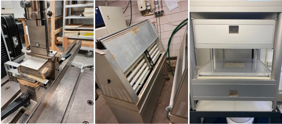
Testopstellingen voor bepalen van (v.l.n.r.): mechanische eigenschappen, UV-bestendigheid en warmtegeleidbaarheid.
