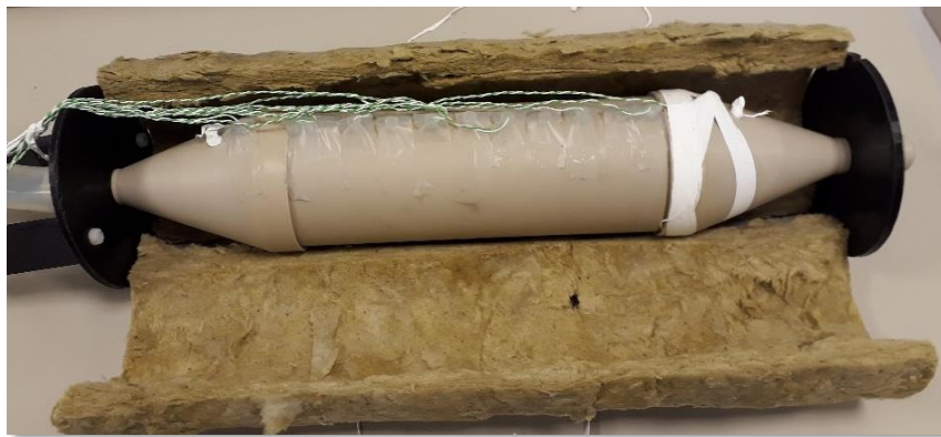
De reactor gemaakt van PEEK. Duidelijk zichtbaar zijn de thermokoppels
