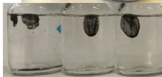
Figuur 6: Coatings naar oplossing in water (niet gecrosslinked, gecrosslinkt, gecrosslinkt met weekmaker)
