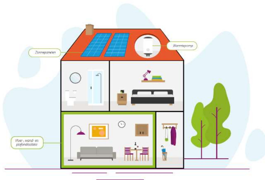
Figuur 1: Thermisch compartimenteren. Het warme compartiment is groen omlijnd.
