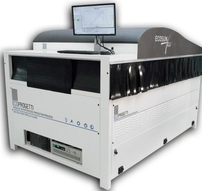
Figuur 2: Deze IV-tester van het merk ECO Progetti meet de IV-curve van elk PV-halffabrikaat onder STC-omstandigheden ( T=25\text{ }^{\circ}\text{C} en Instraling is 1000\text{ W/m}^2 ).
