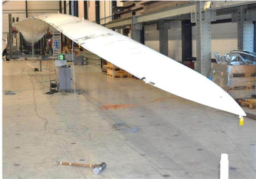
Figure 2. Het LM 56.9P2 rotorblad in de WMC test hal voor de eigenfrequentie test
