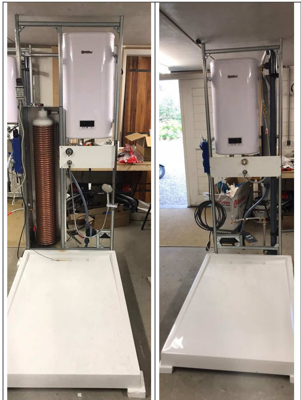
Figuur 4 Links proefopstelling voor VitaalDouche met helix warmtewisselaar, rechts proefopstelling voor VitaalDouche met pijp-in-pijp warmtewisselaar.
