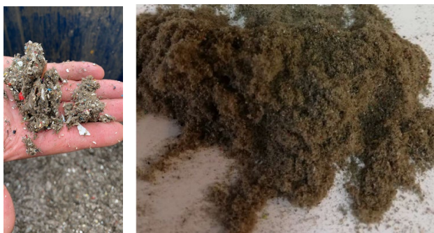
Figuur 5: Geperst afvalwater (links) en gerecyclede cellulose (rechts).
