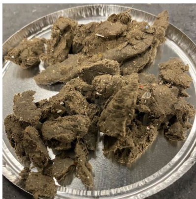
Figuur 6: Geperst slib, met behulp van een decanteercentrifuge.
