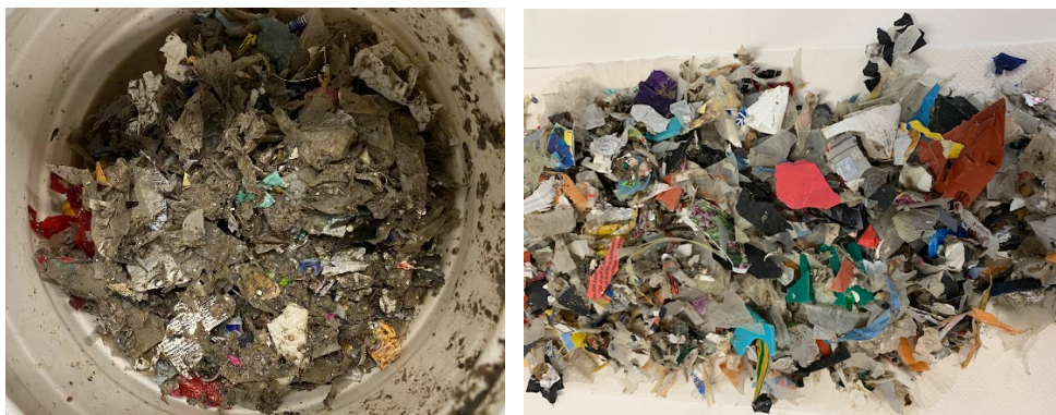
Figuur 1: Restfractie kunststoffen, voor (links) en na (rechts) wassen.
