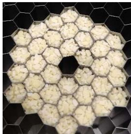
Figuur 48 Gecoate honeycomb gevuld met Na_2S
