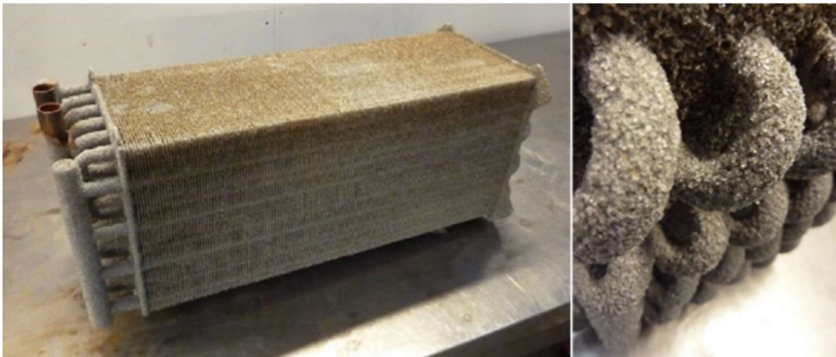
Figuur 5 Lijmen van silicagel op een buis-vin wisselaar
