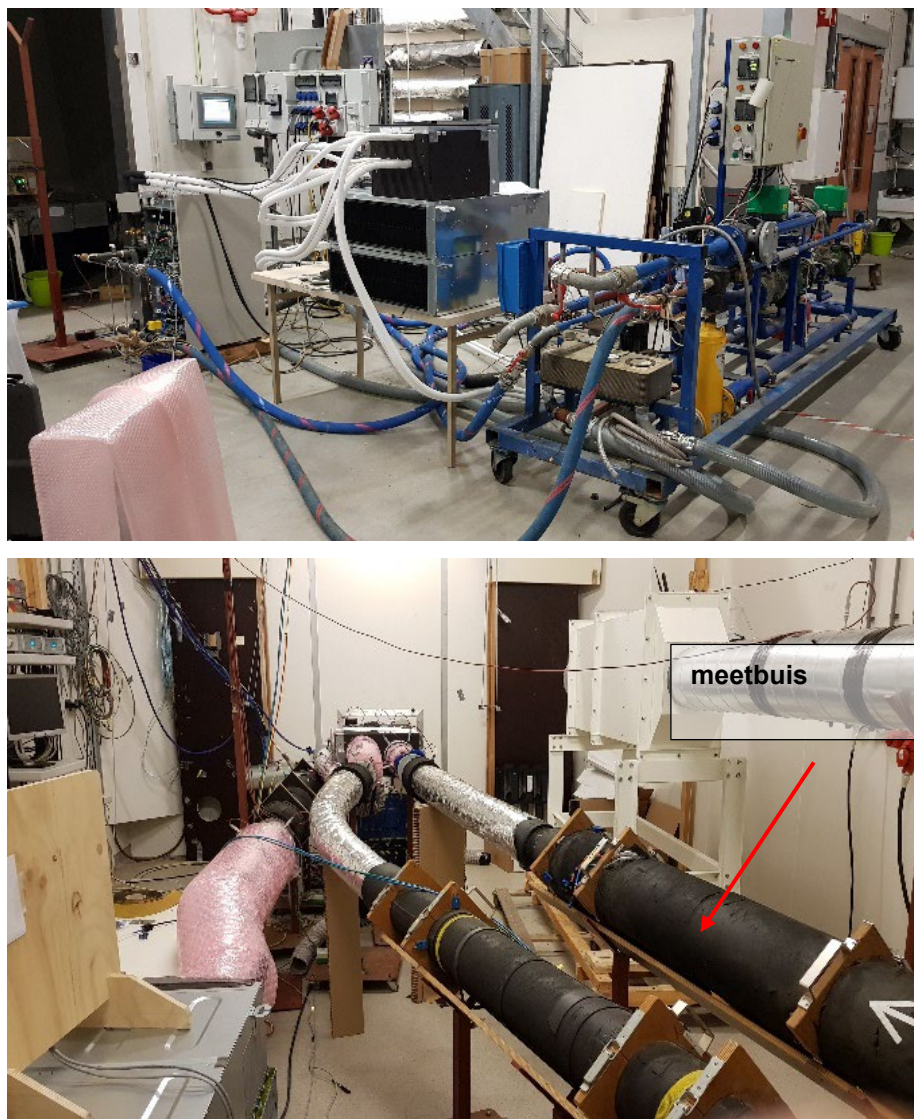
Figuur 20. Hardware in labopstelling. Op de bovenste afbeelding zijn van links naar rechts te zien: de deur naar de klimaatkamer; de compressorunit, de twee dummy-toestellen en de selectiebox; de opstelling voor simulatie van de circulatieleiding. Op de onderste afbeelding zijn te zien: de ventilatorconvector (linksonder), het WTW-toestel (midden achteraan) en het filterhuis (rechtsboven). De drie kanalen met zwart isolatiemateriaal zijn de meetbuizen.
