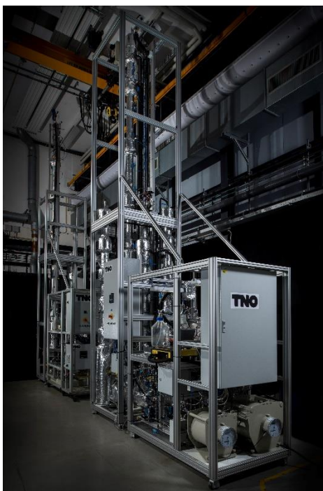
Figuur 3, de kleinschalige CO 2 -afvang testopstelling van TNO.
