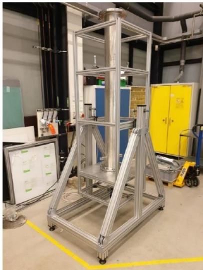
Figuur 4, de testopstelling voor het analyseren van het effect van beweging van schepen op de CO 2 afvangst efficiëntie.
