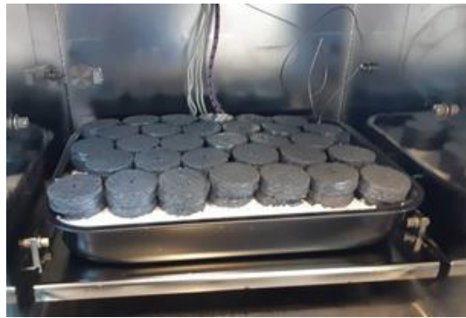
Figuur 2 ENG discs voor impregnatie met PCM in een vacuümoven
