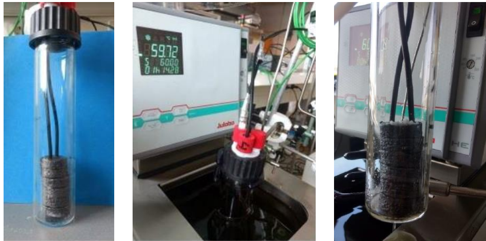
Figuur 8: Testbuis voor bepaling van cyclische stabiliteit van ENG-PCM. (Links) voorafgaand aan test, (midden) tijdens test, (rechts) na 51 smelt-stol cycli
