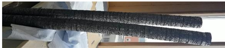
Figuur 2 ENG discs voor impregnatie met PCM in een vacuümoven
