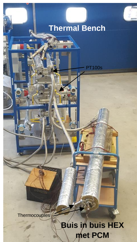
Figuur 4 PCM warmteopslag testbuis, aangesloten op de thermal test bench
