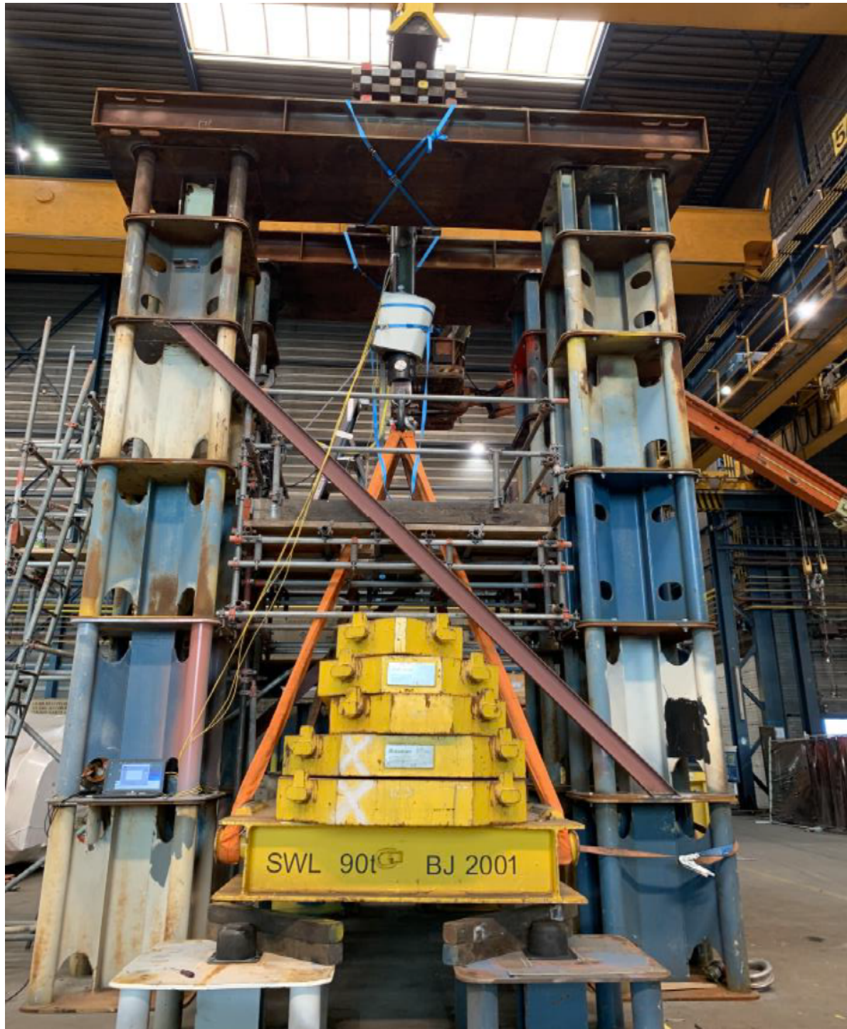
Figuur 12: De lange-duur trektest voor de HSCT-buis met schroefdraadverbinding
