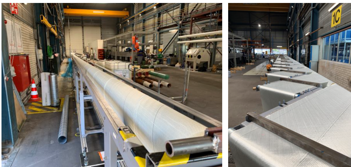
Figuur 1: De wikkelbank voor glasvezeldoeken
