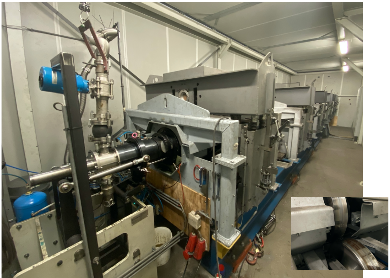
Figuur 5: De centrifuge van de CCM productielijn met links voor de harsinjectie apparatuur en rechts onder een detail van het loopwerk (loopvlak op de matrijs met drie loopwielen) dat in zesvoud op de 12-meter centrifuge is aangebracht
