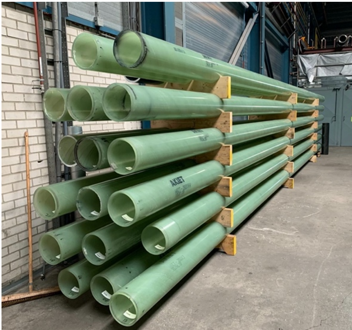
Figuur 16: Gereed product van de eerste serieproductie van Akiet (HSCC) buizen
