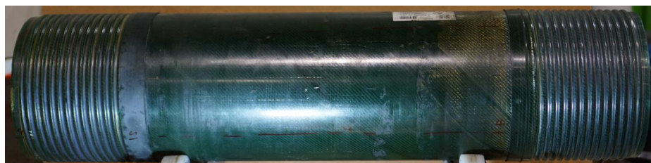
Figuur 11: Het Akiet testsample voor de lange-duur trektest voor de HSCT-buis en verbinding
