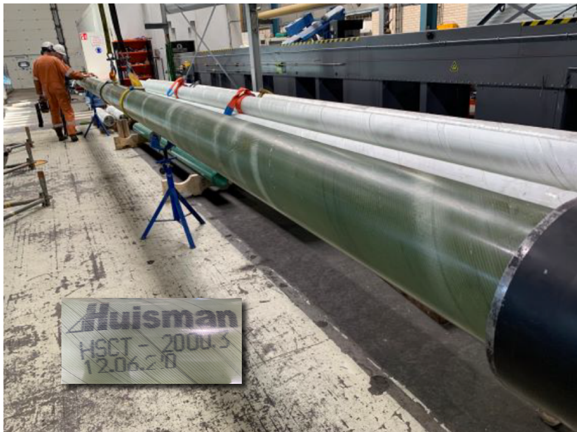
Figuur 9: Een gereed, maar imperfect test sample en gewikkelde glasvezeldoeken op de doorn (met een afbeelding van het ingegoten unieke identificatienummer met productiedatum)
