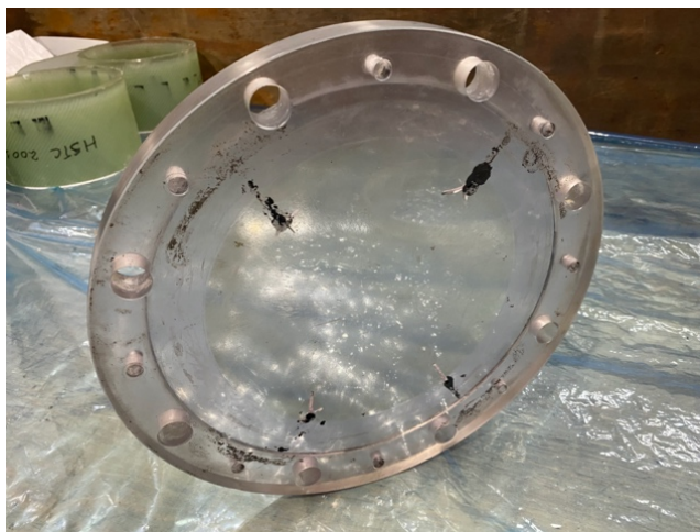
Figuur 7: De polycarbonaat afsluitdeksel van de centrifugematrijs om visuele inspectie (tijdens onderzoek) mogelijk te maken
