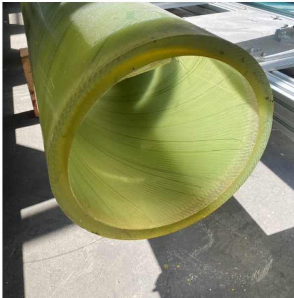
Figuur 4: Akiet buis met 32 lagen in plaats van 24 lagen glasvezeldoek
