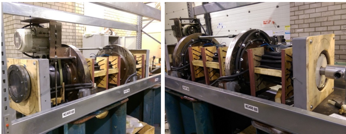
Figuur 3: De 2-meter CCM-testcentrifuge met inductieverwarming
