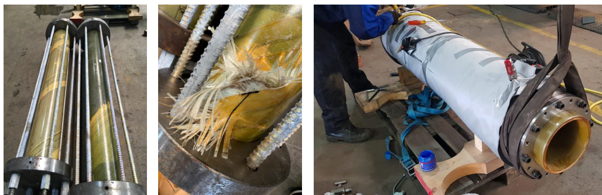
Figuur 10: De interne druk testopstellingen (links en midden) en de externe druk testopstellingen (rechts)
