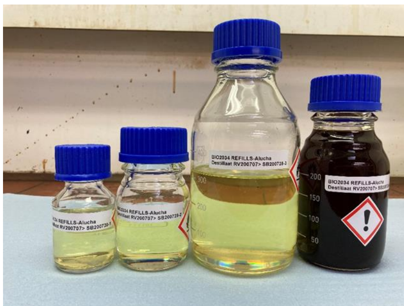
Afbeelding 2.11: Destillaat fractie 1-3 en de bodemfractie 4 [bron: TNO]
