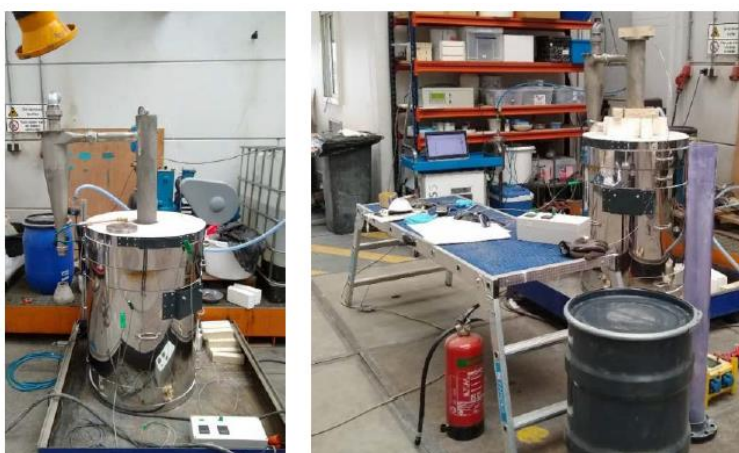
Afbeelding 2.1: Foto's 'nieuwe' BFB lab-opstelling met gas analyzer [Bron: Alucha]
