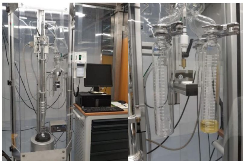
Afbeelding 2.10: TNO “Spinning band” destillatie opstelling [bron: TNO]
