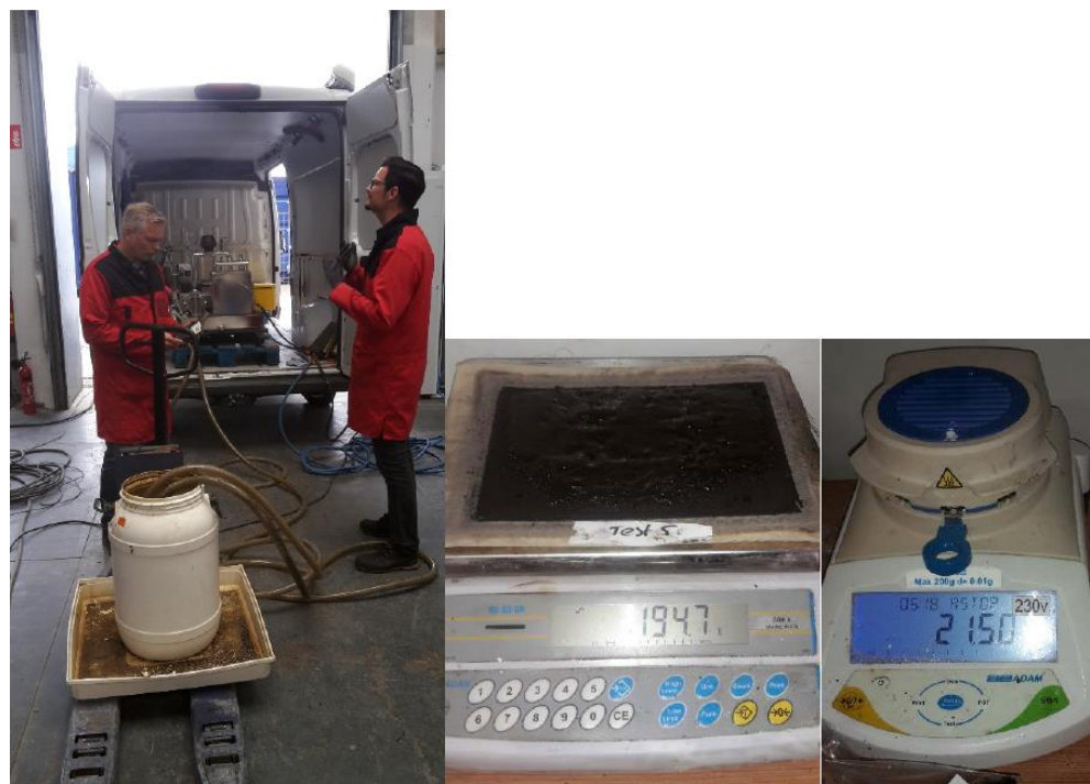
Afbeelding 2.9: testen in Alucha werkplaats met de mobiele filter unit en een van de vaten pyrolyse olie met 5wt% solids en (rechts) solids analyse. [Bron: Alucha]
