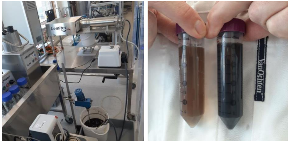
Afbeelding 2.8: Decanter opstelling en test samples van oliefilter testen door TNO [Bron: TNO]
