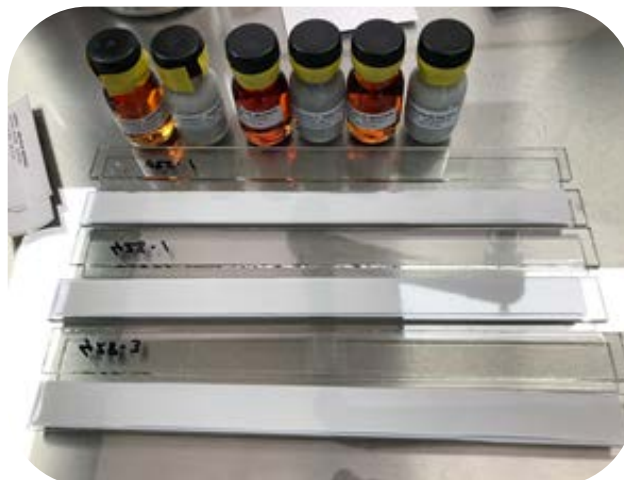
Figuur 11. PA (potjes 1 en 2) en bio-MPA (potjes 3 t/m 6) gebaseerde heldere (clear) en grijze (grijs RAL7035) alkydcoatings, toegepast op een glazen testoppervlak.
