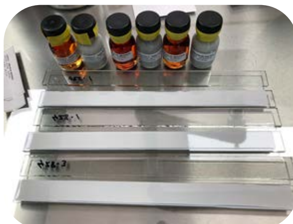
PA (potjes 1 en 2) en bio-MPA (potjes 3 t/m 6) gebaseerde heldere (clear) en grijze (grijs RAL7035) alkydcoatings, toegepast op een glazen testoppervlak.
