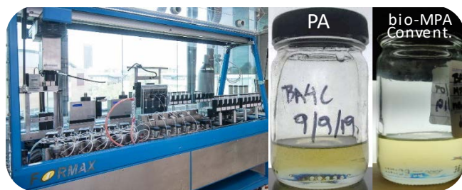
Figuur 8. Links: VLCI's omgebouwde High Throughput (HT) systeem FORMAX. Rechts: met het HT systeem geproduceerde samples van alkydharsen, gebaseerd op fossiel ftaalzuuranhydride (PA) en via conventionele methode gezuiverd bio-MPA.
