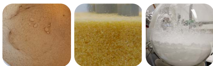
Figuur 4. Verschijning van de samples die op kilogram-schaal binnen BA4C zijn gerealiseerd. Links: ruwe bio-MPA, wat via Biorizon platform technologie werd geproduceerd op kg-schaal. Midden: na zuivering via batchgewijze kristallisatietechnologie 1 (>98,6% zuiverheid). Rechts: na zuivering via een conventioneel zuiveringsprotocol (>99,6%).
