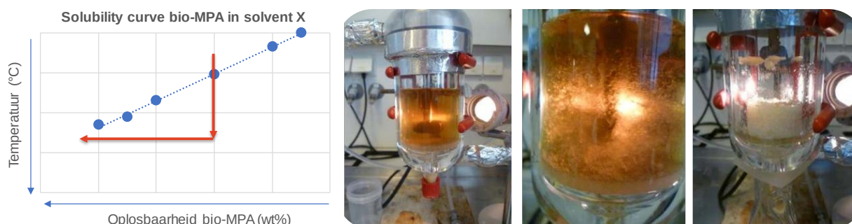
Figuur 6. Links: Voorbeeld van experimenteel bepaalde 'solubility curve', welke de temperatuur afhankelijke oplosbaarheid van bio-MPA in een specifiek oplosmiddel geeft. Rechts: Voorbeeld van een kristallisatie-experiment: van bruine, ruwe productoplossing tot lichte, opgezuiverde bio-MPA.
