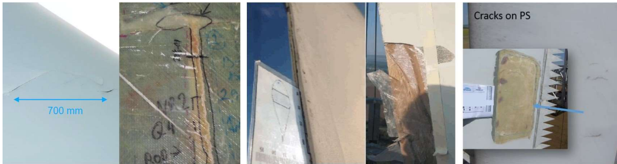
Scheuren (rimpels) in bladen (slechte productie)
